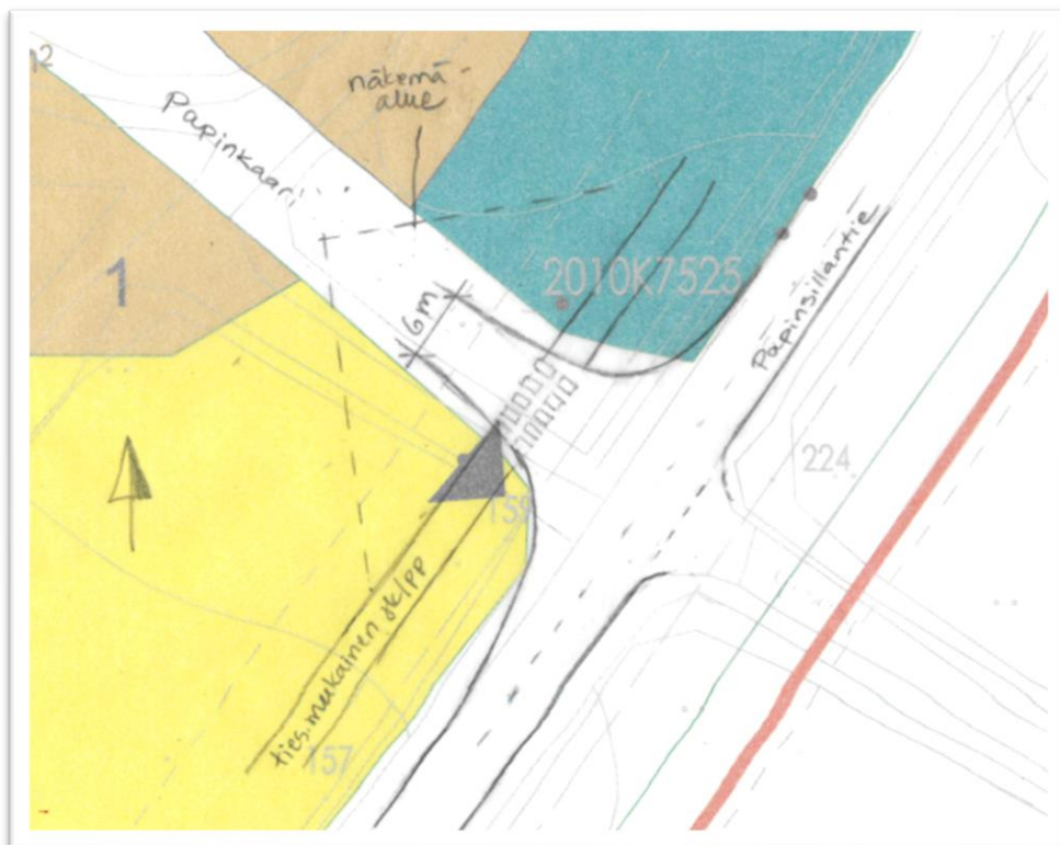
Kuva 10 Uuden Papinsillantien-Papinkaaren liittymän sijainti, tyyppi ja tilantarve. Papinsillantien linjaus sekä tiesuunnitelman mukainen jk/pp-väylä säilyvät sijoillaan.
