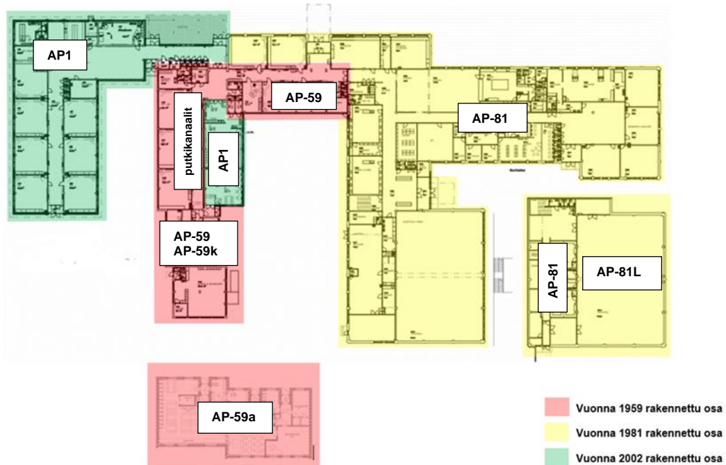
Kuva 2. Alapohjan rakennetyypit, arvioidut sijainnit
