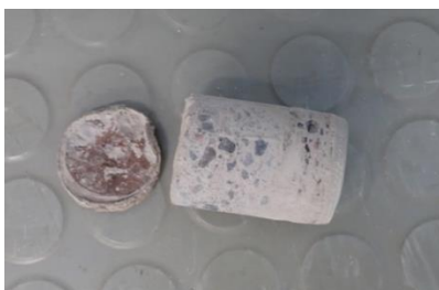
Kuva 19. VP-81 rakenteessa pintalaatan alla havaittiin vanha lattiapäällyste.
